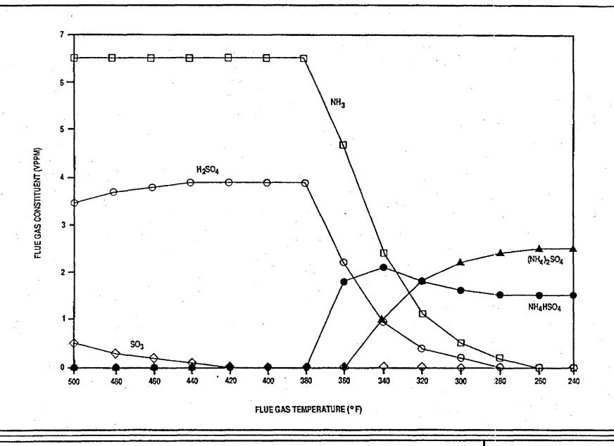
Figure 1 FLUE GAS EQUILIBRIUM COMPOSITIONS - GAS NO. 2
