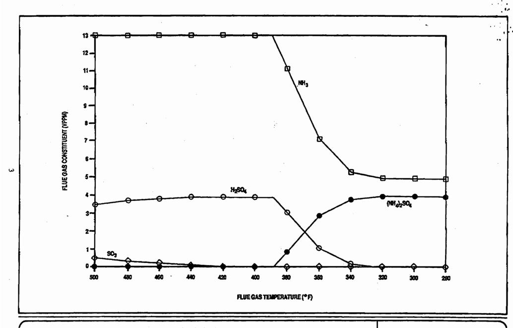
Figure 2 FLUE GAS EQUILIBRIUM COMPOSITIONS - GAS NO. 1
