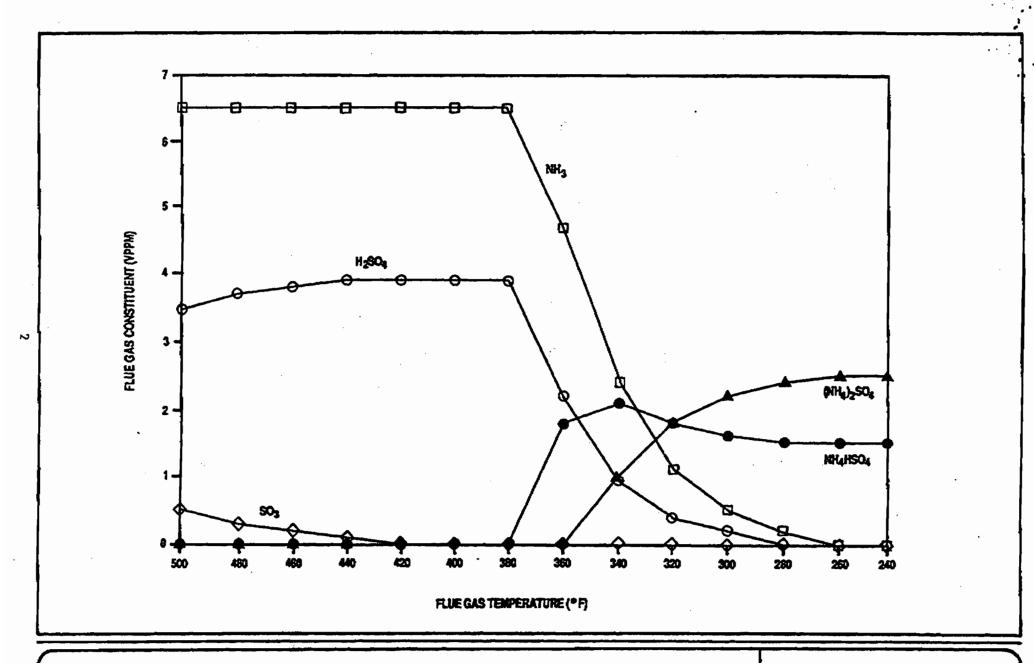
Figure 1 FLUE GAS EQUILIBRIUM COMPOSITIONS - GAS NO. 2
